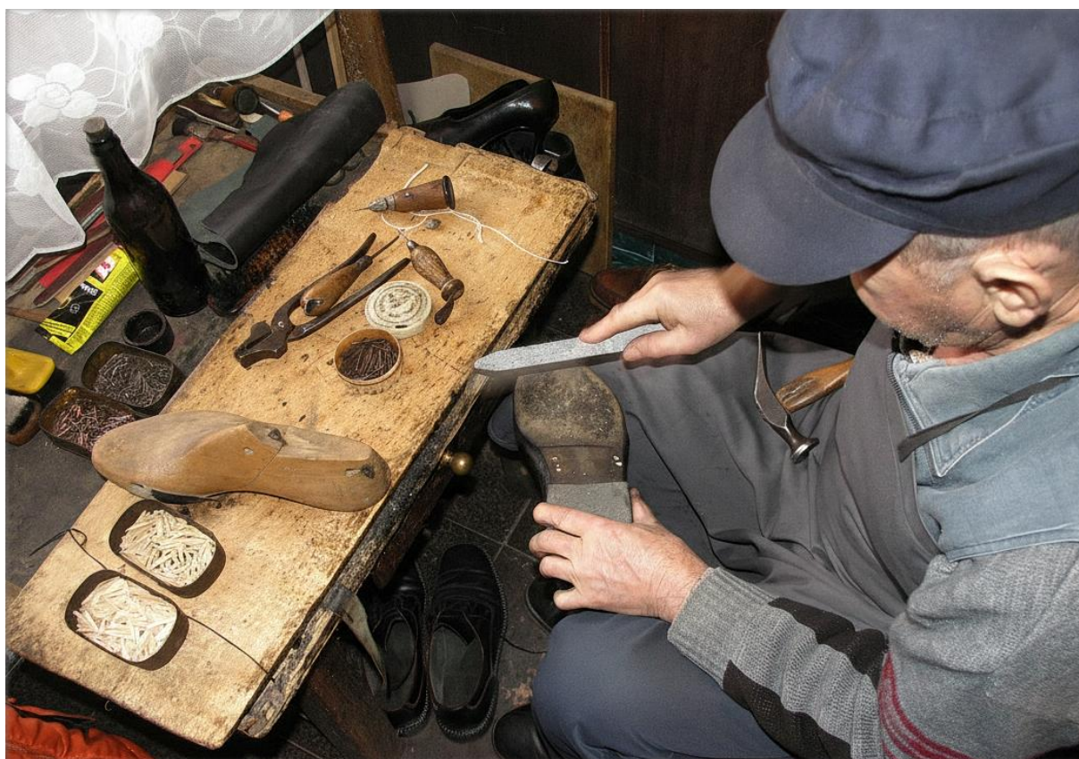
Popravak potplata cipele dok su na stolu uredno poslagani alati: šila, dlijeta, posudica s drvenim klincima i dretva. U pozadini se vide drveni kalupi, neizostavni dio procesa izrade svake cipele po mjeri.
